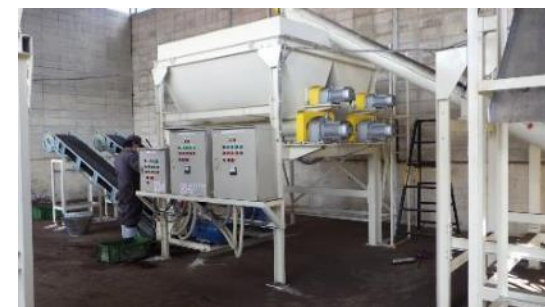
TMペレットマシン シンプルで操作が簡単で、安価にペレットづくりができる。
