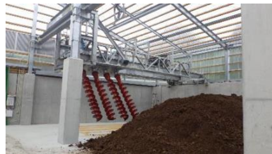
TM片懸垂式発酵攪拌機 10～18m幅×100mの堆肥舎を堆肥高約3mにて堆肥化処理可能な機械設備。
