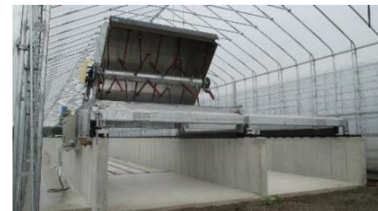
TMロータリー攪拌機 シンプルに投入・取り出しができ、扱いが簡単。
